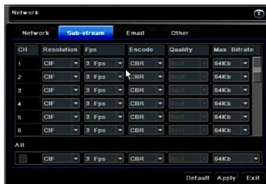
Дополнительный поток позволяет настроить индивидуально параметры передачи видеопотока. Это позволяет, например, записывать видео с максимально возможным качеством и, между тем, передавать видео через сеть с низкой пропускной способностью (как сети сотовой связи). В сетевом сервисе имеется возможность переключения между основным и дополнительным потоком.
